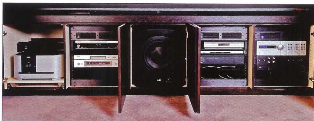
L'ensemble de l'installation est piloté en RF grâce à la Crestron STX-1700.
